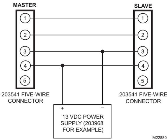
Fig. 20. Cloning jig.
