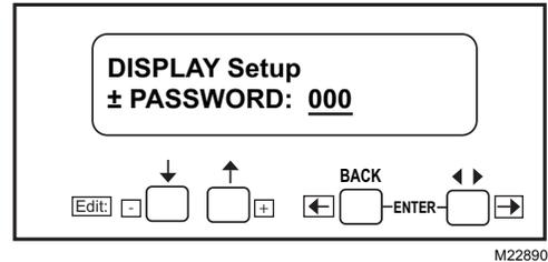
Fig. 21. Display Setup screen.
