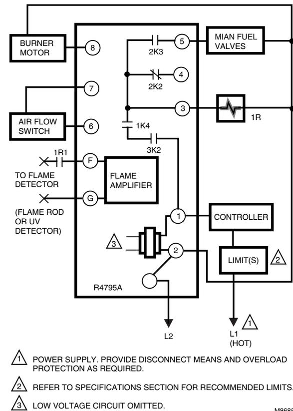
**Fig. 6—Flame detector wiring.**
